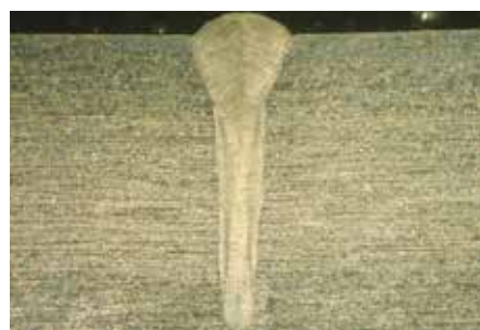
細く深い溶込みが特徴的なレーザ溶接（ファイバーレーザ）
