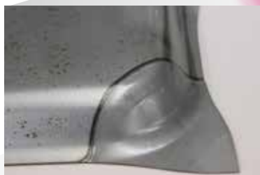
テールードブランク溶接。溶接後のプレス加工にも耐える十分な強度を確保（ファイバーレーザ）
