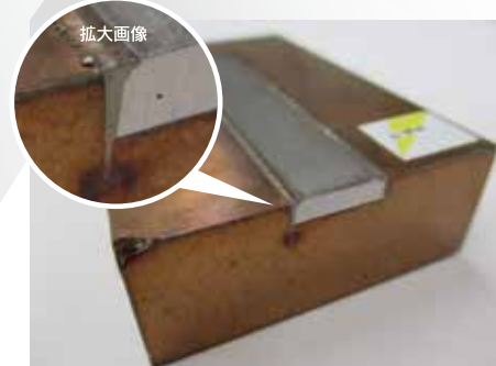
電子ビームによる銅と SUS304 の異種金属溶接。レーザが苦手とする加工も、電子ビーム加工で深い溶込みを得られる。（電子ビーム）
