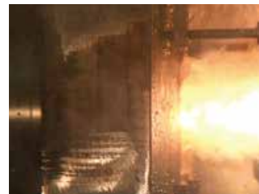
▲t=50mm の SUS 厚板の水中切断を実現
