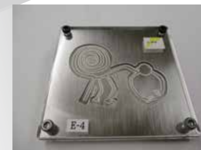
セラミック切断の加工例。素材はアルミナ (t0.9mm) で、0.4mm 幅で複雑形状をカットできる（YAG レーザ）
