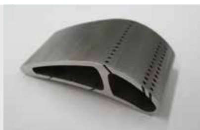
タービンブレードを模した斜め孔あけ加工のサンプルワーク（ファイバーレーザ）
