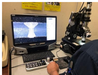
高倍率マイクロスコップで溶接状況をチェック
