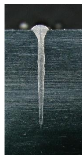
レーザー溶接の断面の一例。 写真は高出力のファイバーレーザーによるもの。
