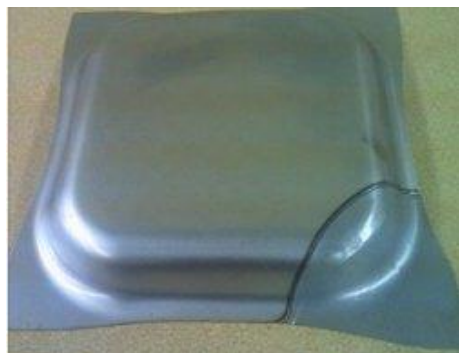
自動車業界 鋼板のテーラードブランク溶接
