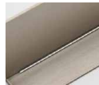
■チタン 板厚t1.0 T字継手溶接
