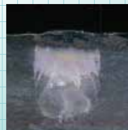
A5052で3mmの溶込み深さを確保
