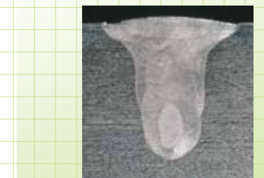
SUS304で2.0mmの溶込み
