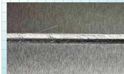
A5052、板厚1.0mmの突合せ溶接。 ビード幅2.0mm
