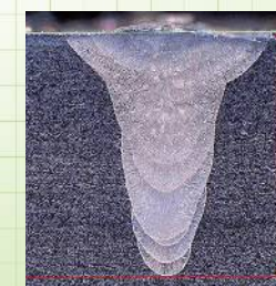
SUS304で3.0mmの深溶込み (FH-450)
