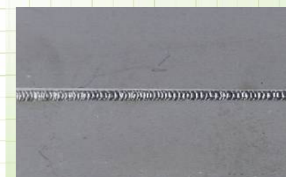
SUS304、板厚1.0mmの突合せ溶接。 ビード幅0.8mm
