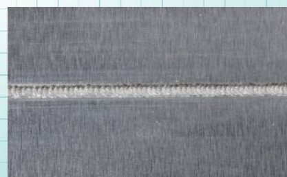
A5052、板厚1.0mmの突合せ溶接。 ビード幅1.7mm
