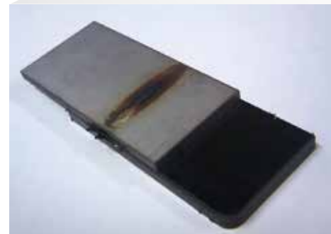
樹脂と金属の異材接合(ファイバーレーザー)
