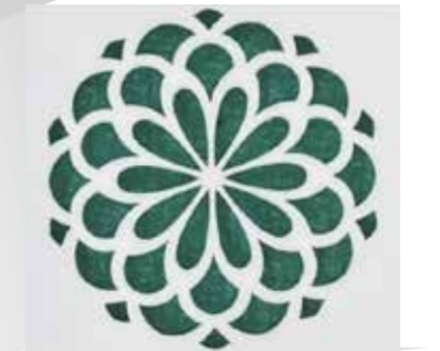
割れやすく条件設定が難しいアルミナ板(10.7mm)のトリミング加工(ファイバーレーザー)
