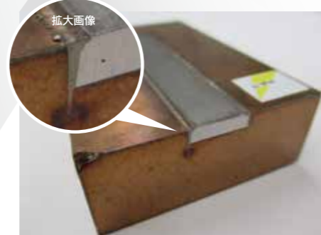
電子ビームによる銅とSUS304の異種金属溶接。レーザーが苦手とする加工も、電子ビーム加工で深い溶込みを得られる。(電子ビーム)
