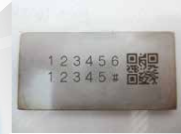
レーザーマーキングによりステンレス製の部品に品番とQRコードを印字して識別した例(ファイバーレーザー)
