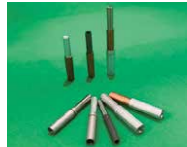
短パルスレーザーの特性を活かして溶融させず「杭」をうつつ形で素材をつなぎとめるステッキング加工による異種接合(ナノ秒レーザー)
