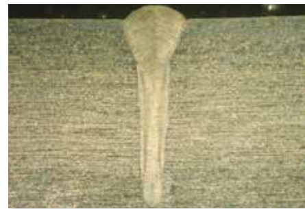
細く深い溶込みが特徴的なレーザー溶接(ファイバーレーザー)
