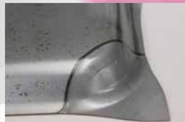
テラードブランク溶接。溶接後のプレス加工にも耐える十分な強度を確保(ファイバーレーザー)
