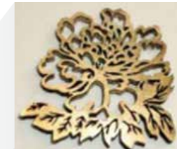
板厚0.8mmの18金の素材をレーザー切断でブローチを製作(ファイバーレーザー)
