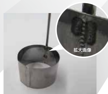
タングステンとタンタルの異材接合。タングステンの薄板側から貫通溶接でタンタルの棒材を接合した(ファイバーレーザー)
