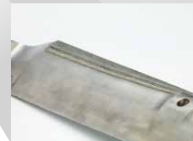
タービンブレードのエッジへの肉盛り加工(ファイバーレーザー)
