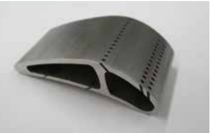
タービンブレードを模した斜め孔あけ加工のサンプルワーク(ファイバーレーザー)
