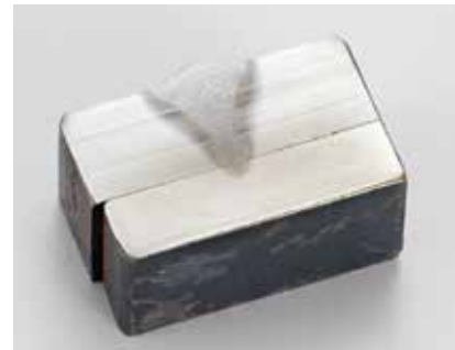
板厚10mmのSUSを1パスでステイク溶接(レーザー・アークハイブリッド溶接)
