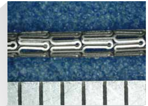
φ1mmのパイプを切り出してステントを製作。下の1目盛が1mm(ファイバーレーザー)
