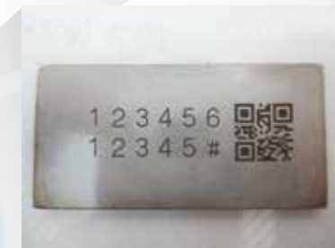
レーザマーキングによりステンレス製の部品に品番とQRコードを印字して識別した例（ファイバーレーザ）
