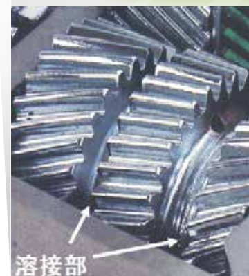
自動車部品、ギアアセンブリの溶接事例（ファイバーレーザ）
