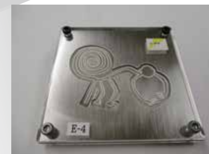
セラミック切断の加工例。素材はアルミナ（φ0.9mm）で、0.4mm幅で複雑形状をカットできる（YAGレーザ）
