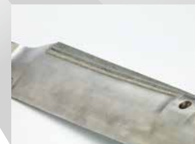
タービンブレードのエッジへの肉盛り加工（ファイバーレーザ）
