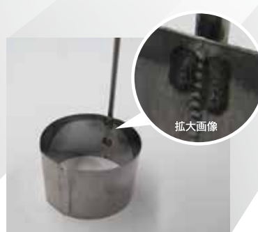
タングステンとタンタルの異材接合。タングステンの薄板側から貫通溶接でタンタルの棒材を接合した（ファイバーレーザ）
