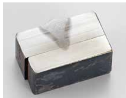
板厚10mmのSUSを1パスでスティック溶接（レーザ・アークハイブリッド溶接）
