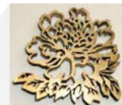
板厚0.8mmの18金の素材をレーザ切断でブローチを製作（YAGレーザ）
