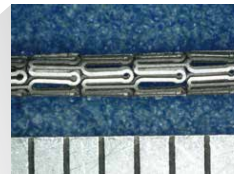
φ1mmのパイプを切り出してステントを製作。下の1目盛が1mm（ファイバーレーザ）
