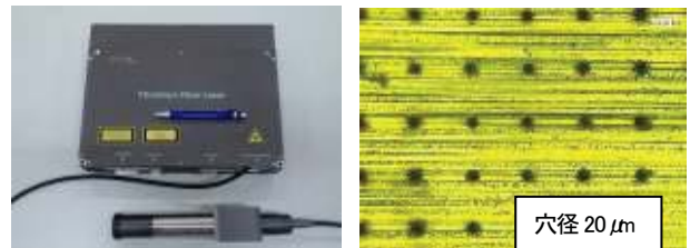
図 6 パルスファイバーレーザ(左)と穴加工例(右)
